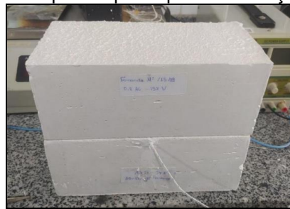
Figura 2 - Montagem dos corpos de prova para a execução do ensaio Fio-quente.
