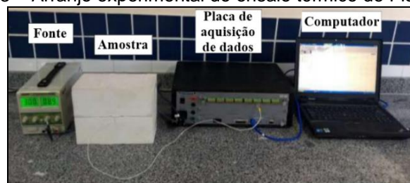
Figura 3 – Arranjo experimental do ensaio térmico de Fio-quente.
