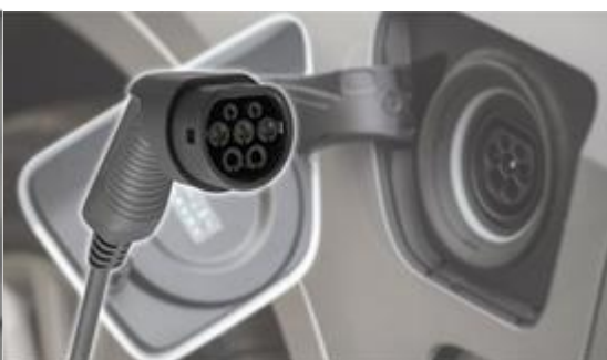
Figura 7: Conector IEC 62196-2 Fonte: Bensen (2024)
