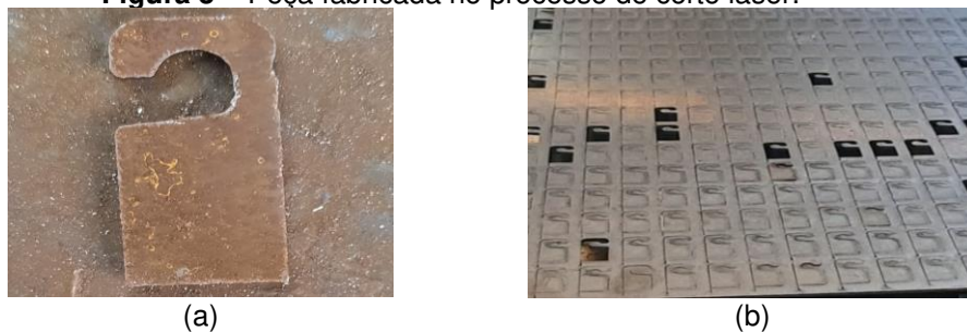
Figura 3 – Peça fabricada no processo de corte laser.
