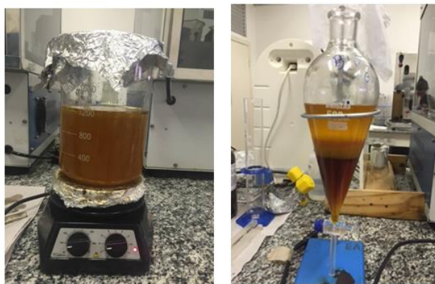
Figura 2: Transesterificação e decantação
