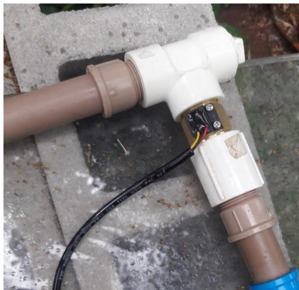
Figura 5- Tê utilizado para um ângulo de 90°.
