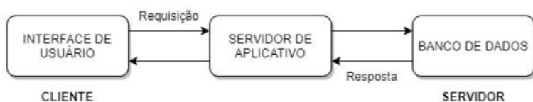
Figura 4 - Arquitetura cliente-servidor de três camadas
