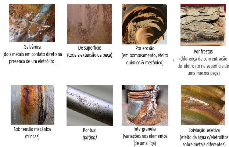
Figura 6. Vários tipos de corrosão
