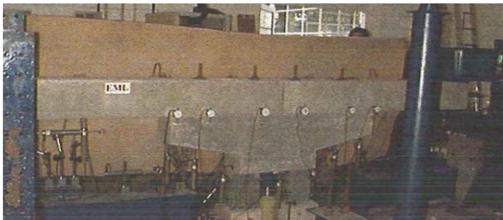
Figura 9. Esquema geral de ensaio para ligação viga-pilar estudada Fonte: Soares (1998)
