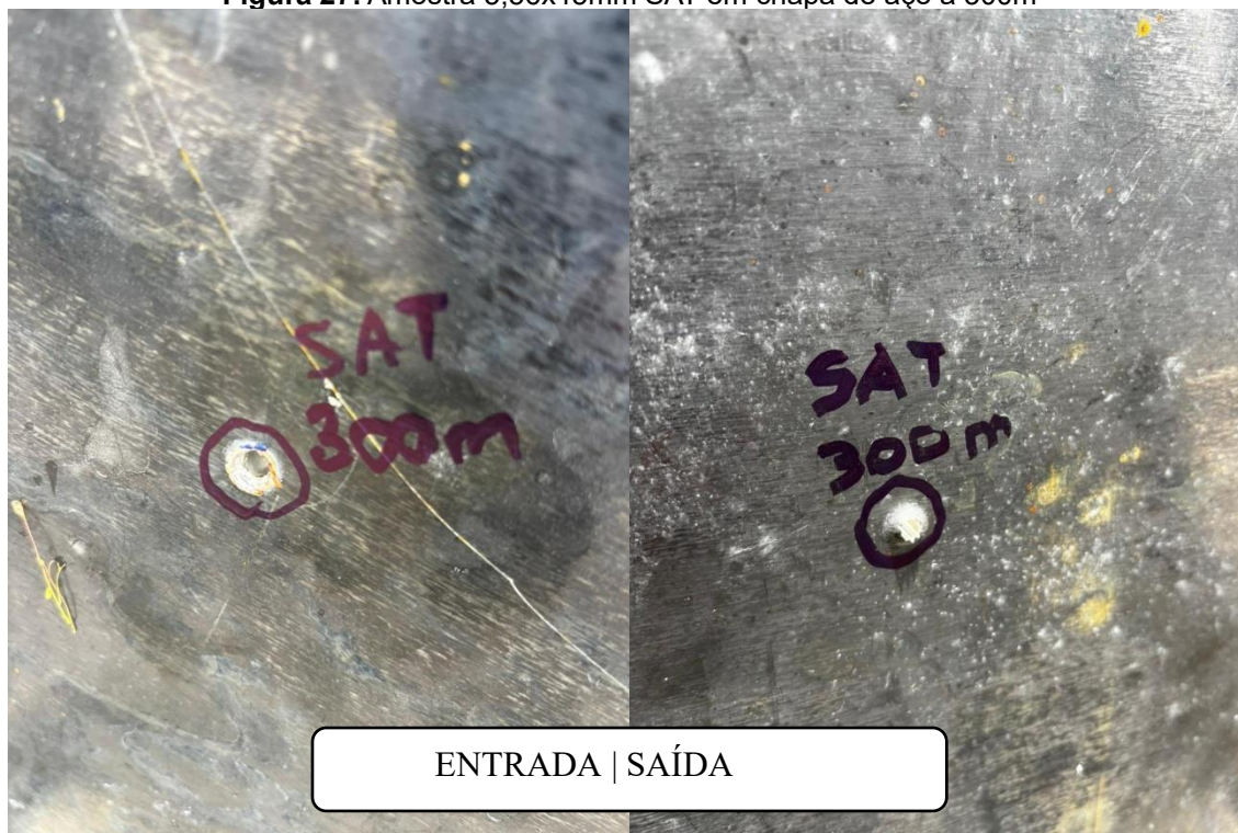
Figura 27. Amostra 5,56x45mm SAT em chapa de aço a 300m
