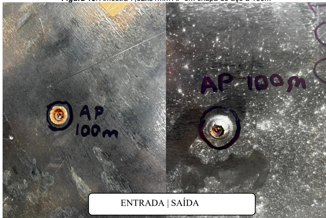
Figura 15. Amostra 7,62x51mm AP em chapa de aço a 100m
