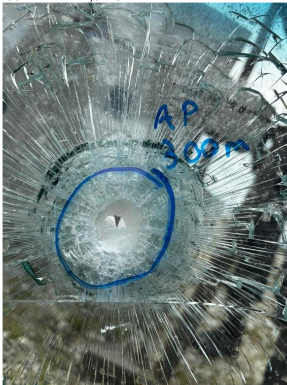
Figura 33. Amostra 7,62x51mm AP em vidro blindado a 300m
