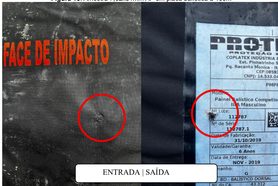
Figura 16. Amostra 7,62x51mm AP em placa balística a 100m
