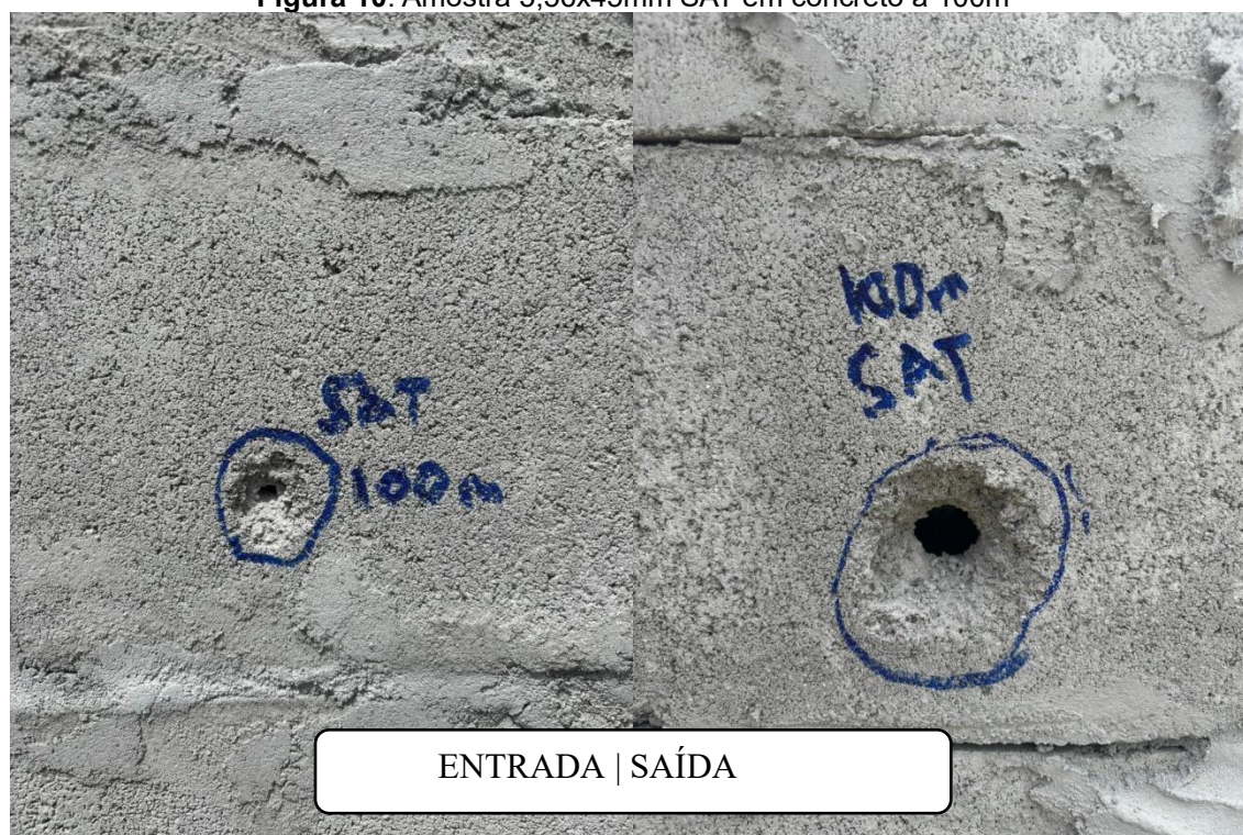
Figura 10. Amostra 5,56x45mm SAT em concreto a 100m
