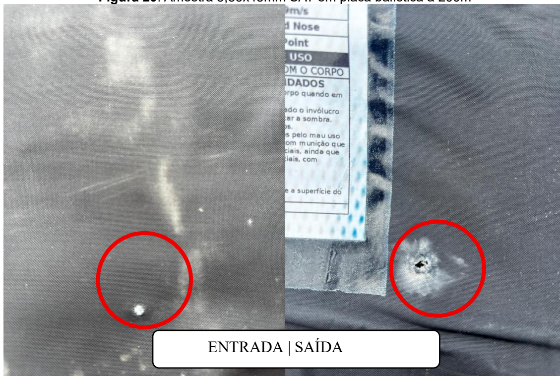
Figura 20. Amostra 5,56x45mm SAT em placa balística a 200m
