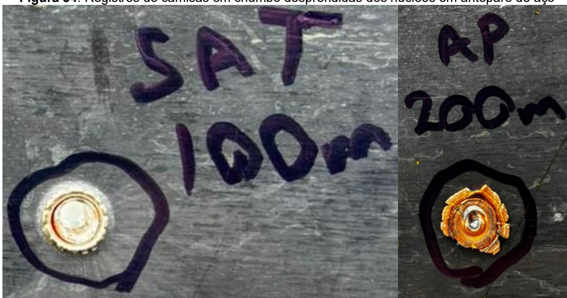
Figura 34. Registros de camisas em chumbo desprendidas dos núcleos em anteparo de aço
