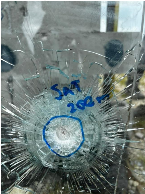
Figura 21. Amostra 5,56x45mm SAT em vidro blindado a 200m
