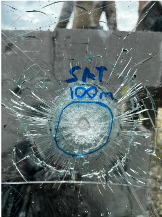
Figura 13. Amostra 5,56x45mm SAT em vidro blindado a 100m
