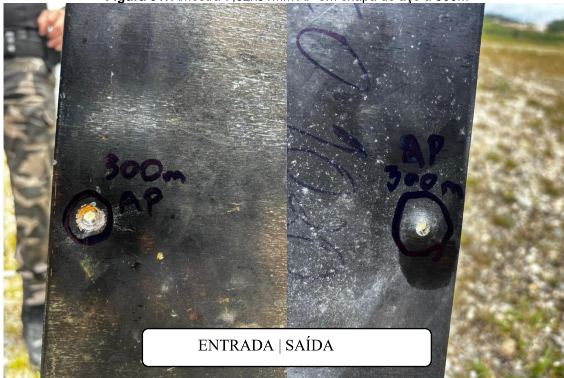
Figura 31. Amostra 7,62x51mm AP em chapa de aço a 300m
