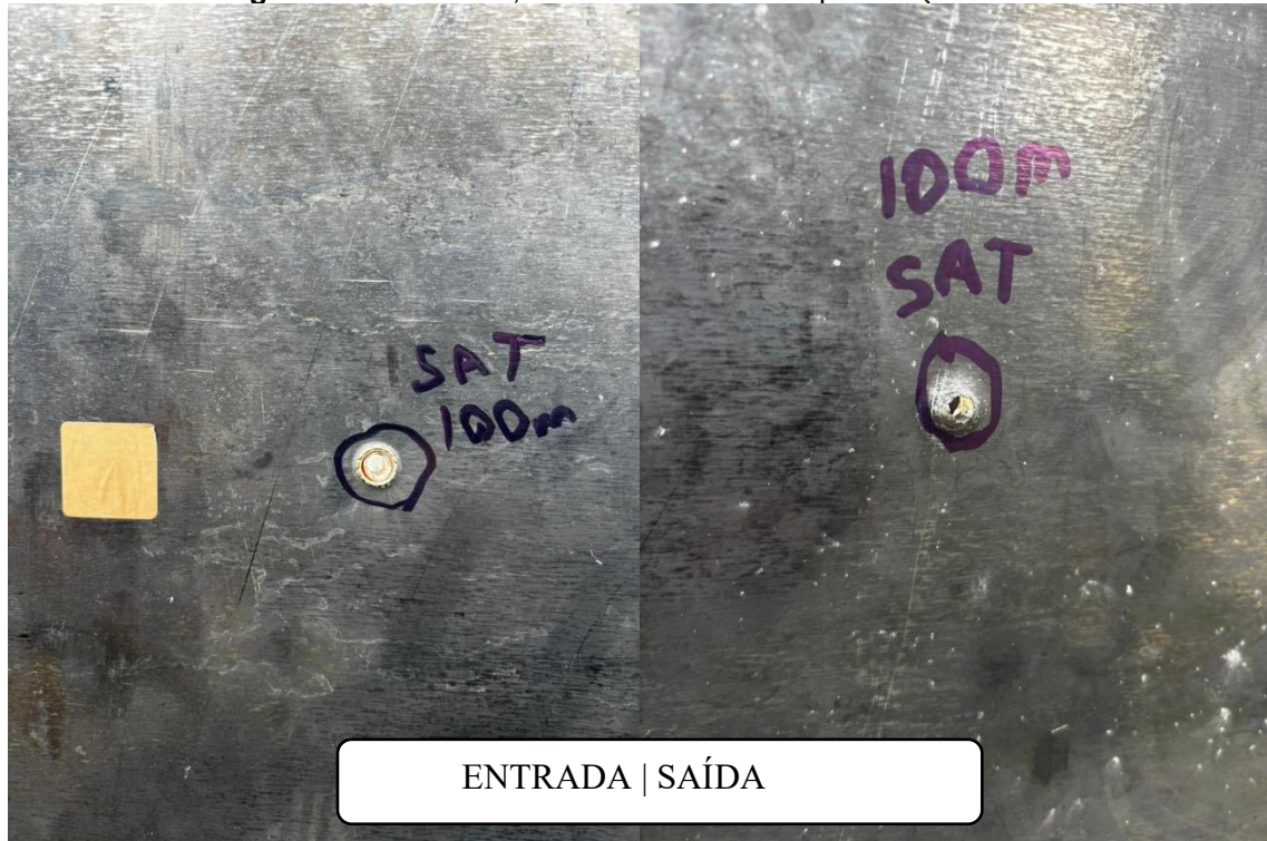
Figura 11. Amostra 5,56x45mm SAT em chapa de aço a 100m
