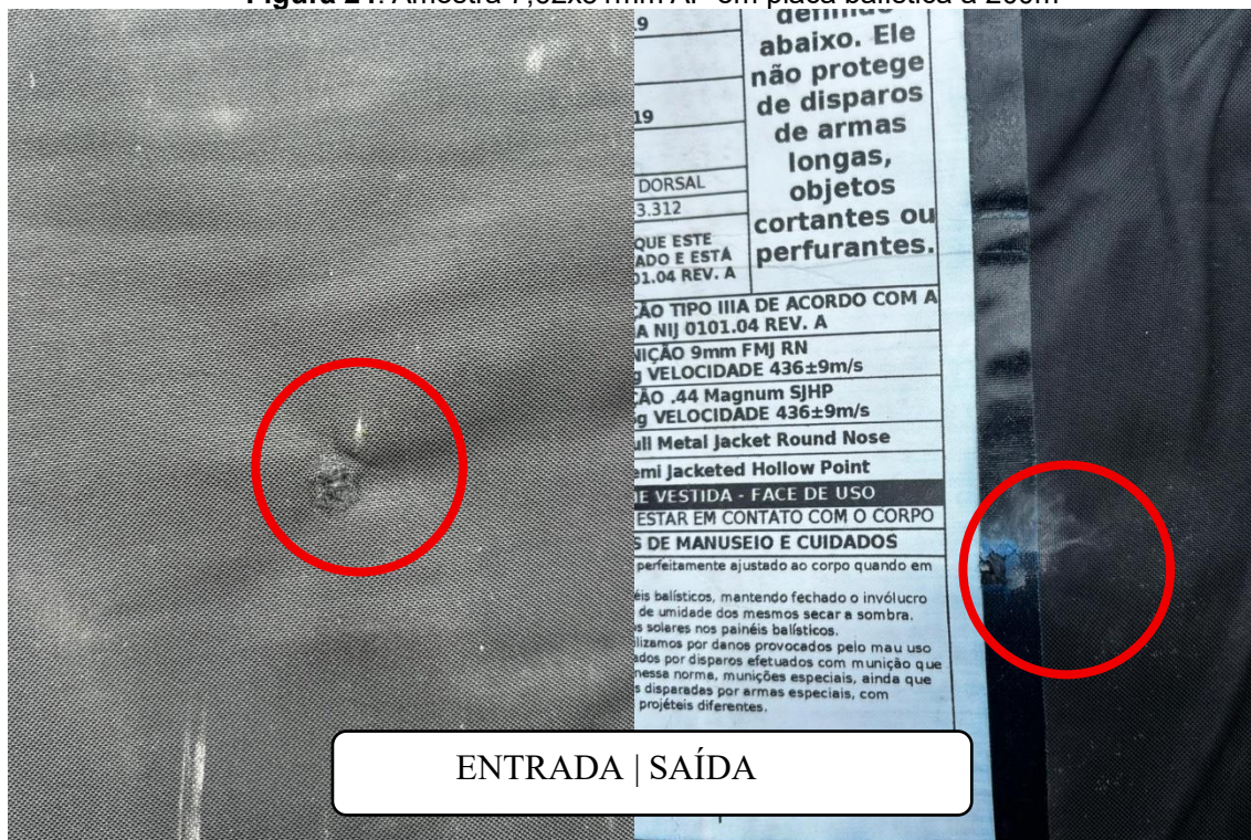
Figura 24. Amostra 7,62x51mm AP em placa balística a 200m
