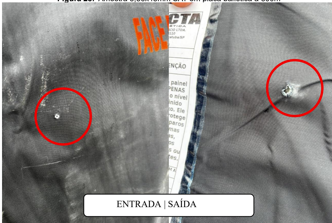
Figura 28. Amostra 5,56x45mm SAT em placa balística a 300m
