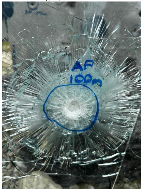
Figura 17. Amostra 7,62x51mm AP em vidro blindado a 100m
