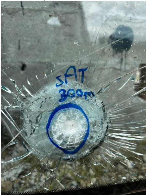
Figura 29. Amostra 5,56x45mm SAT em vidro blindado a 300m
