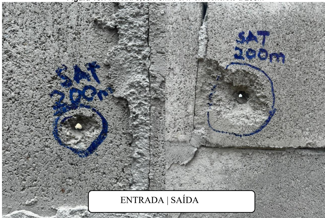
Figura 18. Amostra 5,56x45mm SAT em concreto a 200m
