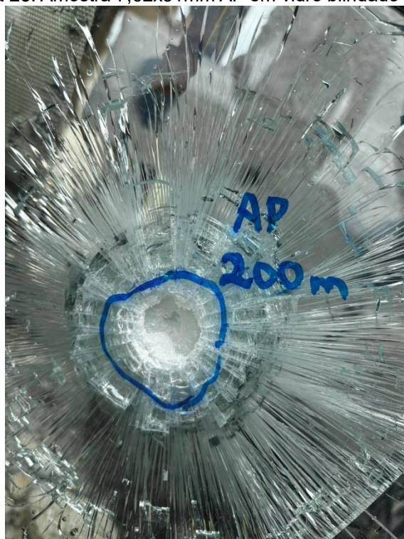
Figura 25. Amostra 7,62x51mm AP em vidro blindado a 200m
