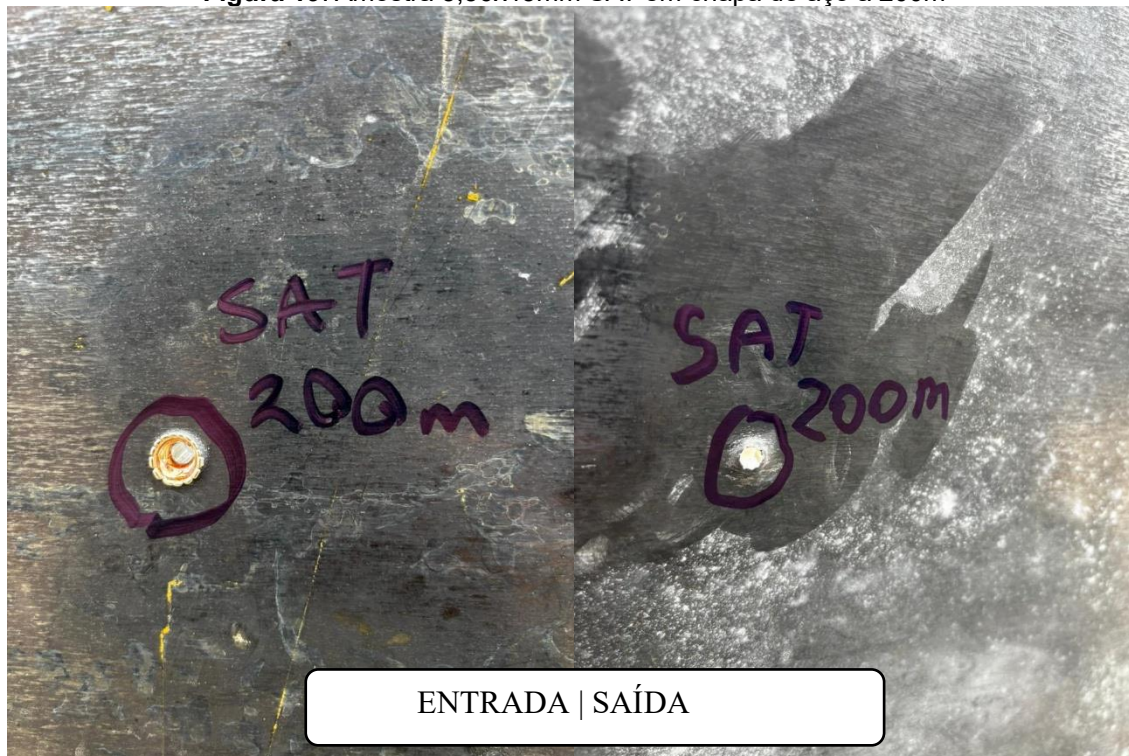
Figura 19. Amostra 5,56x45mm SAT em chapa de aço a 200m
