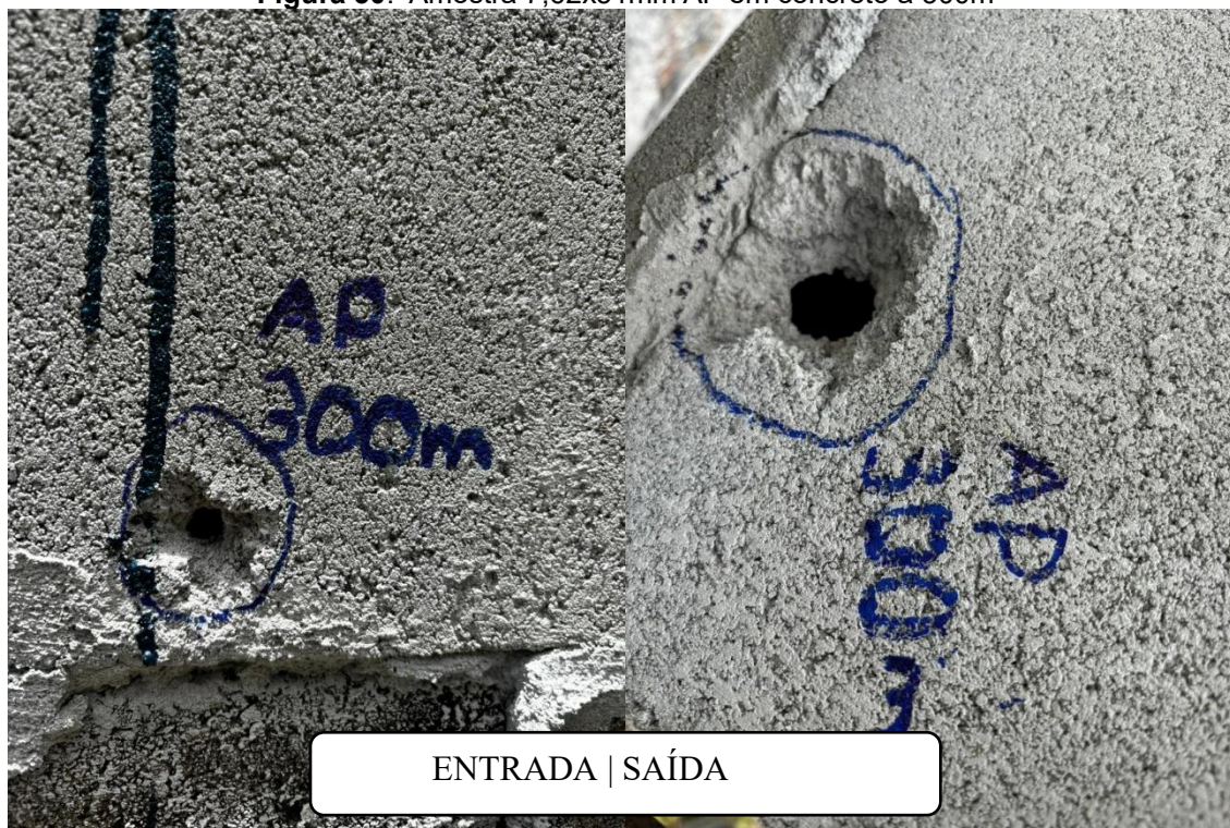
Figura 30. Amostra 7,62x51mm AP em concreto a 300m
