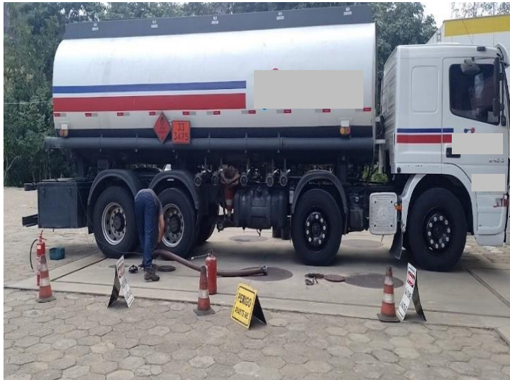
Engate de mangueira na descarga selada do tanque
