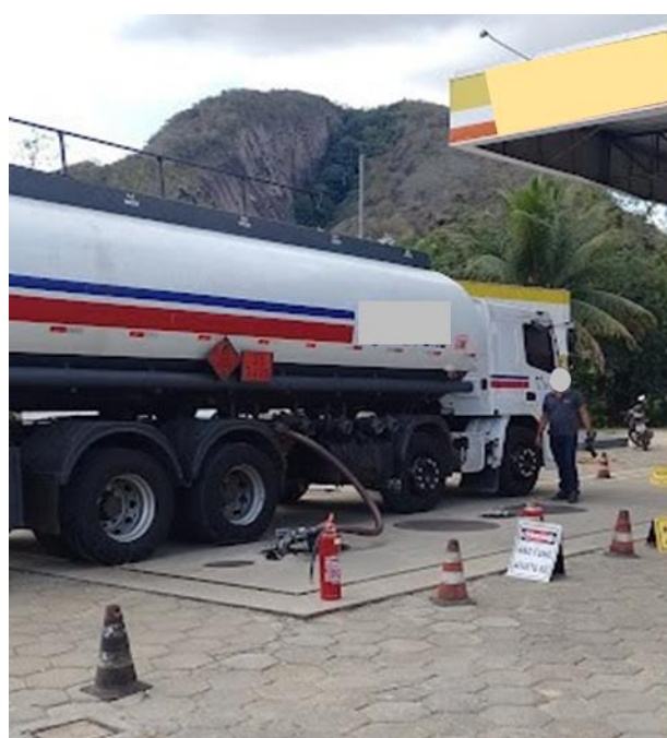
Engate de mangueira no caminhão
