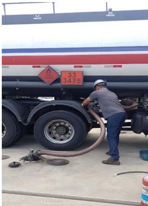
Engate de mangueira no caminhão
