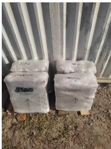
Figura 5. Prismas preparados para ensaio de compressão
