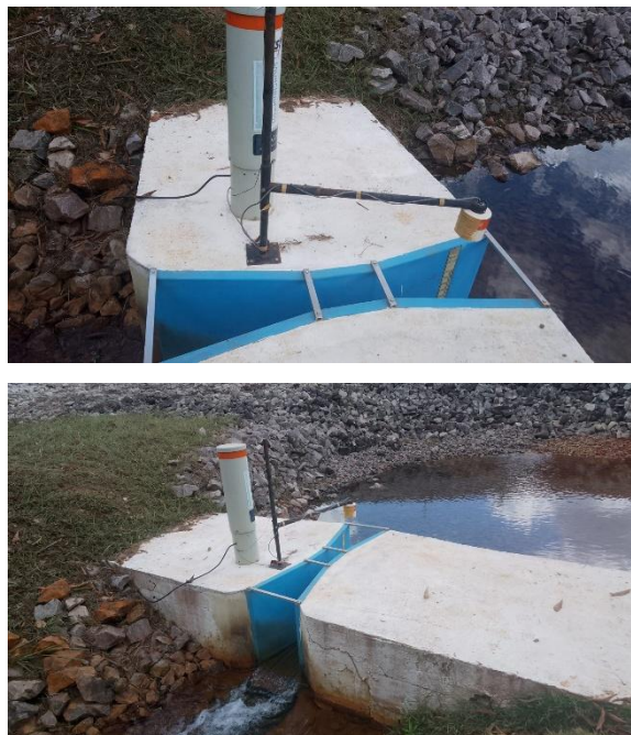
Figura 3. Sistema de monitoramento de turbidez
